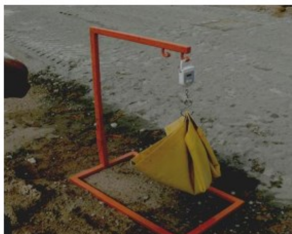
Ważenie tacki pomiarowej ze spoiwem
